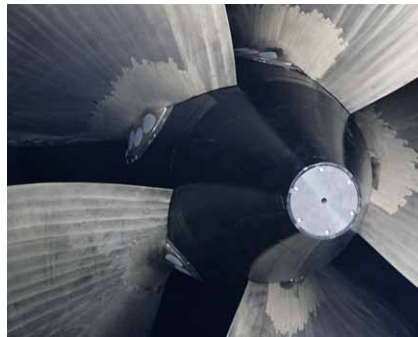
Detailansicht Kaplan turbine
